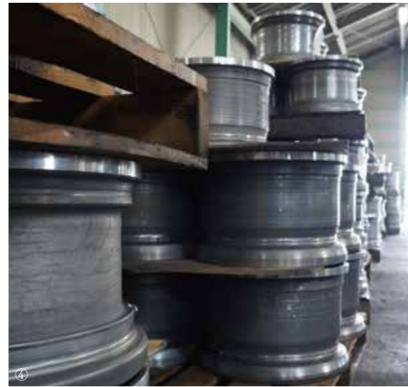
①8000トンプレス機 ②工場に運ばれる鍛造前のホイール。 ③熱を当てながらリムを伸ばしていく。 ④掘削を待つホイール
