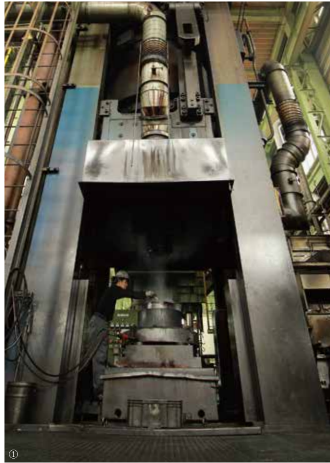
①8000トンプレス機 ②工場に運ばれる鍛造前のホイール。 ③熱を当てながらリムを伸ばしていく。 ④掘削を待つホイール
